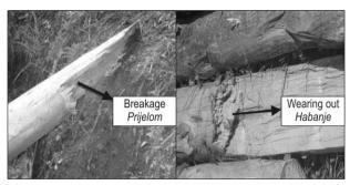
Fig. 2 Types of damage of transported logs *Slika 2.* Vrste oštećenja na privučenim trupcima
